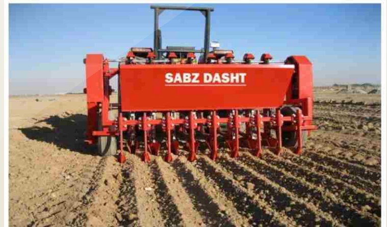
شکل ۲-۱۳- دستگاه کاشت سوخچه با امکان تنظیم فاصله بین ردیفها
