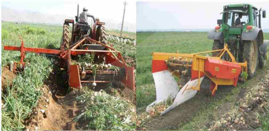
شکل ۸-۳- دستگاه سرزنی پیاز (سمت چپ)، تیغه های دوار زیر دستگاه با امکان تنظیم ارتفاع (سمت راست)
