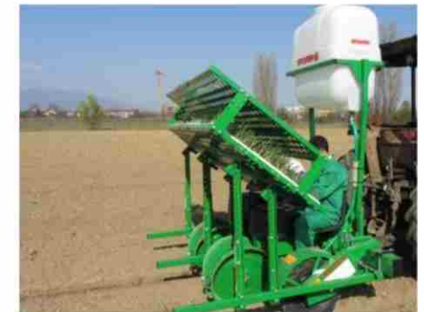
شکل ۲-۶- دستگاه نشاکار نیمه اتوماتیک جهت کاشت نشاء پیاز به صورت ۵ نفره و ۲ نفره
