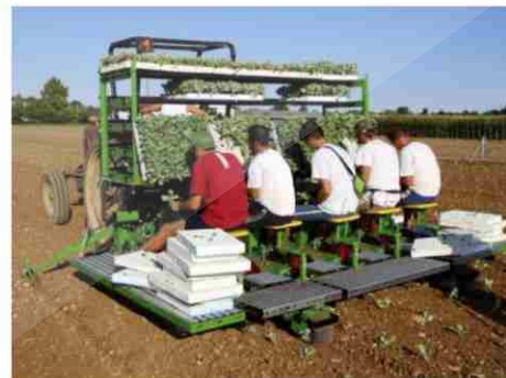
شکل ۲-۶- دستگاه نشاکار نیمه اتوماتیک جهت کاشت نشاء پیاز به صورت ۵ نفره و ۲ نفره
